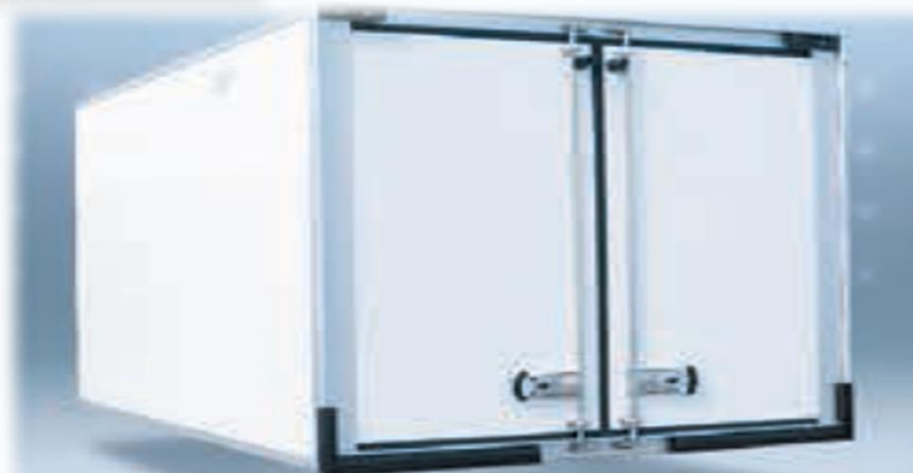
Композитні панелі (харчовий гелеобразний шар - поліефір - поліуретан), оснащені алюмінієвими вставкам
